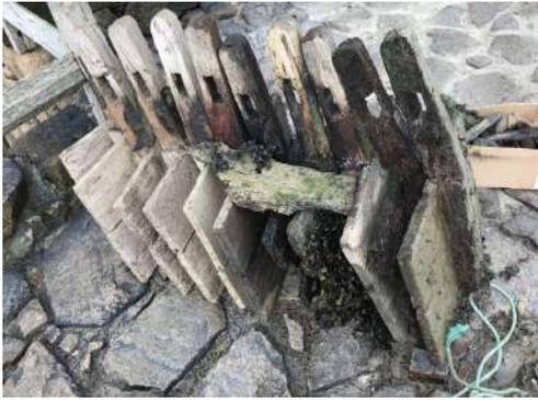
*Les pales de l'ancienne roue ont été déposées afin de ne pas les abîmer et de faciliter la dépose.*
